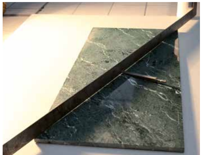
Fig. 9 – Kontroll av planhet ved levering.
