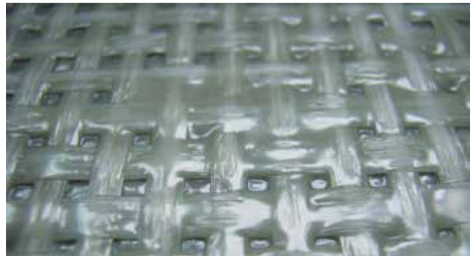
Fig. 7 – Nærbilde av ekstra glatt baksidebelegning. I dette tilfellet skal flislimet modifiseres med kunststoffdispersjonen PCI Lastoflex®.
