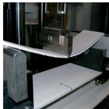
Dette bildet er tatt under bøyetesten og viser tydelig den ekstreme kraften som den uelastiske og stive PCI Periplan Extra kan motstå når den forsterkes med PCI Armeringsmatte GFM og PCI Armeringsmatte GFS.
