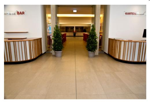
Mittig wurde die Bewegungsfuge vom Eingang bis zur Garderobe geplant, um ein ästhetisches Gesamtbild der großformatigen Fliesen zu erzielen. Mit Hilfe des PCI Systems "Gleichmäßiges Fugenbild" konnte die gestalterische Konzeption realisiert werden, denn das System erlaubt das Überfliesen der Bewegungsfugen im Estrich.
